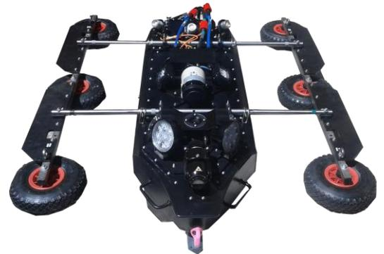
MS-Raft de CISCREA: Robot d'inspection de conduites en charge
